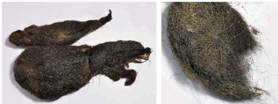
Bild 30 a och b. Drevning av växtfiber i vått respektive torrt tillstånd. Foto: Tomas Jakobsson, Länsmuseet Gävleborg.
